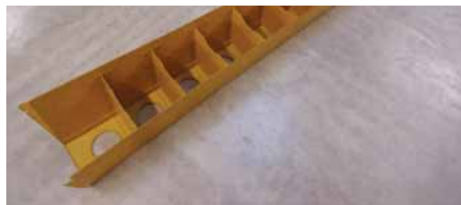
Exemple de projet réalisé avec la PME PIKA : Support technique à l'industrialisation Longérons de voilure RTM
