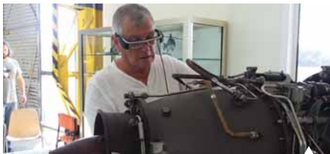
TAC : inspection avec l'aide d'un expert distant
